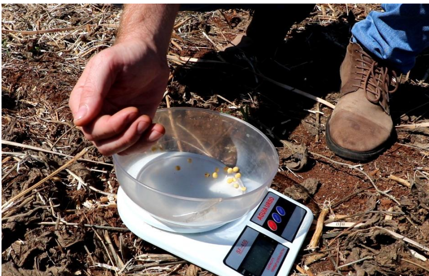
Pesagem dos grãos recolhidos na área demarcada e realização do cálculo médio das perdas durante a operação de colheita. Para o cálculo, multiplica-se a pesagem obtida por 10 mil metros, o equivalente a um hectare. Unidade de produção de João Adair Picollo, Novo Barreiro (04/2021).
