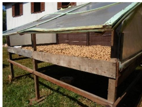
Família Tabaldi - Cruzaltense/RS secador solar- estufa.
