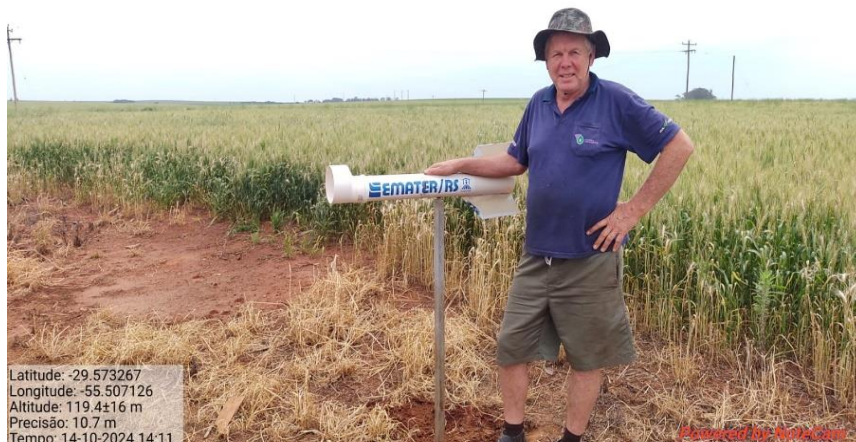
Coletor de esporos para controle de ferrugem-asiática da soja na propriedade de Sérgio Luiz Migotto, em Manoel Viana (outubro/2024).
